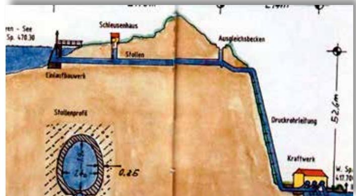
**Querschnitt des Wasserzulaufs vom Soyensee nach Vorderleiten**
