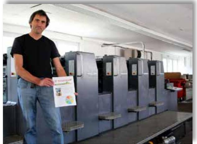
**8.** In der Wasserburger Druckerei Weigand wird unsere fertige Datei noch einmal mit Farbkonvertierung und der Acrobat-Preflight auf technischen Mängel getestet. Anschließend werden, je nach Seitenanzahl, die benötigten Druckplatten hergestellt. Die Wasserburger Fachmänner, hier auf dem Bild Christian Wolf, nennen das lustigerweise „Ausschießen“. Sollte alles im passenden Zustand sein, werden die Drucker aktiv.
